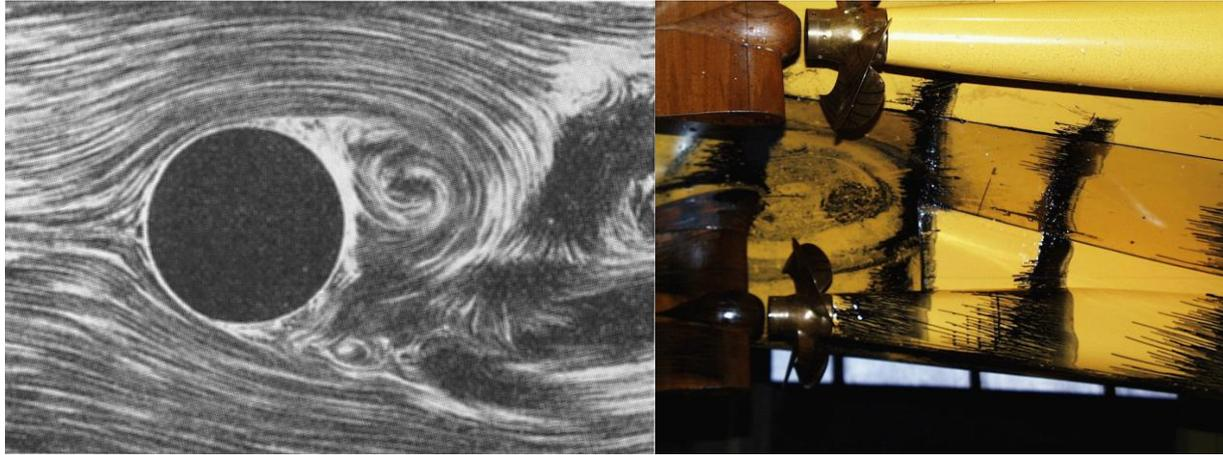
**Abb. 18:** Beispiele für eine Strömungsablösung. Links erkennt man, dass die Strömung dem stumpfen Körper hinten (rechts) nicht mehr folgt. Im Farbanstrichversuch eines Schiffsmodelles erkennt man das daran, dass die Farbe nicht verlaufen ist (die Strömung steht an der Stelle).
