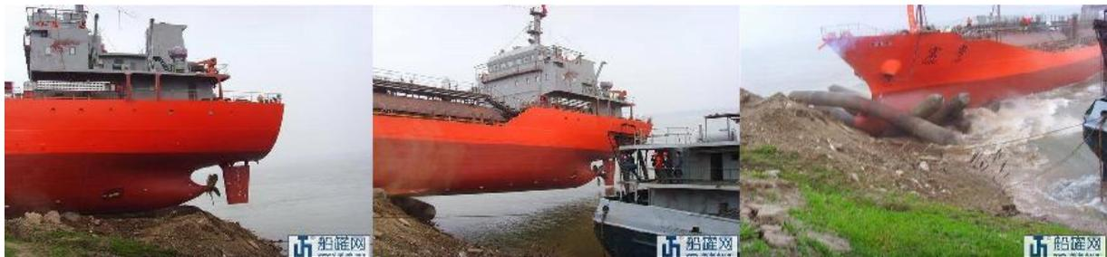
**Abbildung 3: Stapellauf eines Schiffes auf einer sogenannten „Greenfield“- Werft.**
