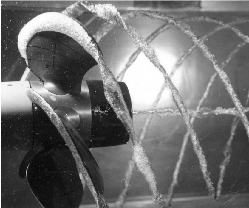
**Abbildung 19: Kavitationsbildung an einem Propeller. Quelle: HSVA**
